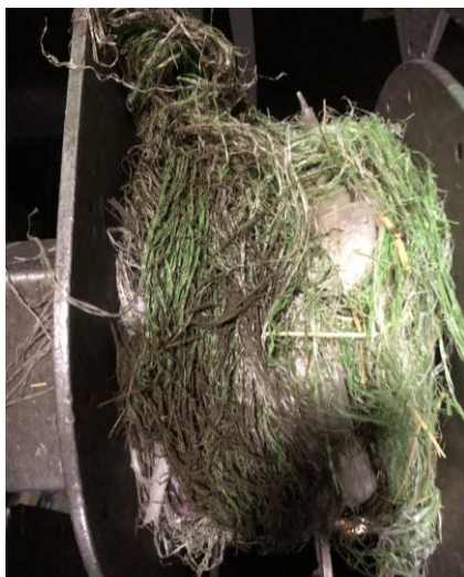
Les filets et les cordes s'enroulent dans les disques et les convoyeurs. Source : Sani Éco inc.
